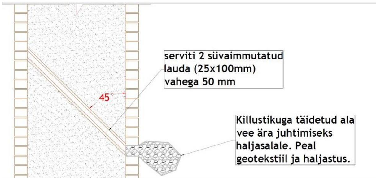
Skeem 2. Sademeveerenni põhimõtteline skeem
