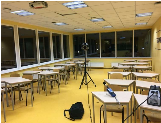
Foto 2 – õhumüra isolatsiooni mõõtmine, müraallikas õppeklassis 77-1
