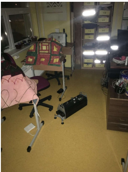
Foto 3 – löögimüra isolatsiooni mõõtmine, löögimüramasin õppeklassis 77-4
