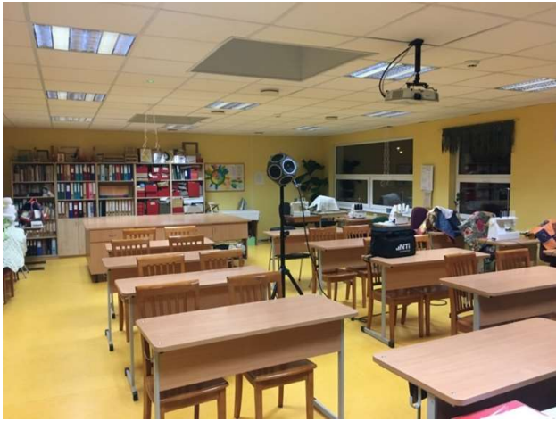
Foto 1 – õhumüra isolatsiooni mõõtmine, müraallikas õppeklassis 77-4
