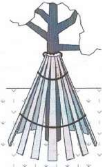
Ehituse ajaks paigaldatav ajutine puu tüvekaitse. Allikas: EVS 939-3:2020 joonis 6.1
