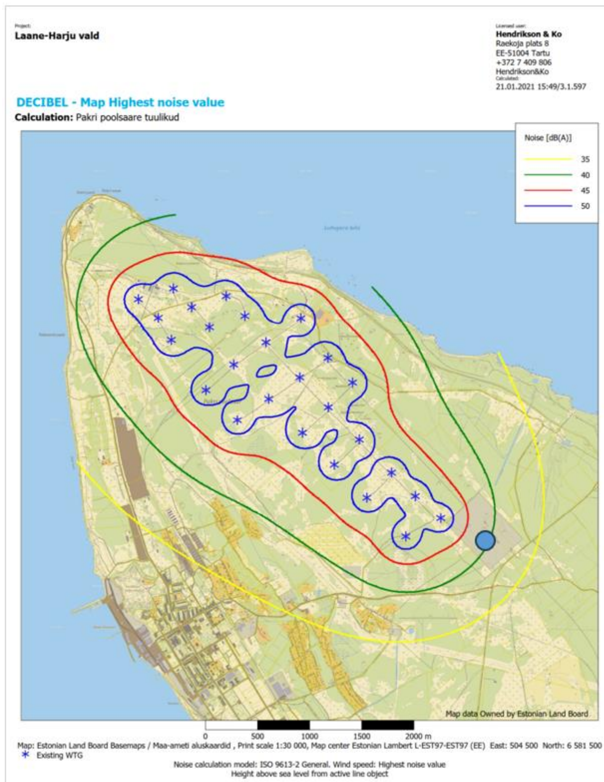
Joonis 45. Müratase Pakri poolsaarel asuvatest olemasolevatest tuulikutest. Allikas: Hendrikson&Ko. Lõpladustuspaiga alternatiivne asukoht PAL on tähistatud sinise täpiga
