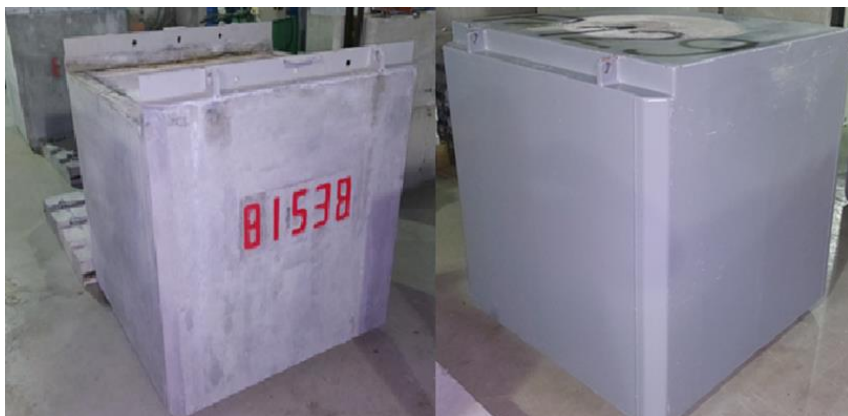
Joonis 3. Paldiski vaheladustuspaigas asuvad betoneeritud radioaktiivsete jäätmete konteinerid. Allikas: Eksortus/AS A.L.A.R.A.
