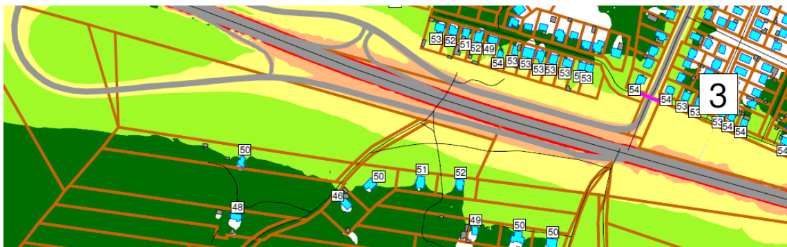
Joonis 4 Väljavõte Tallinna ringtee km 30,1 – 34,5 Kanama - Valingu põhiprojektist: liiklusemüra modelleerimine”, 2017 ehitusjärgne olukord müratõkkeseinteta kaardist öisel ajal.
